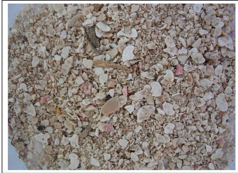
Figura 30. Muestra F 1. Sedimentos de la línea de playa del cayo Francisquí Medio. Se observan fragmentos de *Halimeda*, pelecípodos, gatrópodos y algas rojas. Los sedimentos no presentan alteración diagenética. Escala horizontal: 5 cm.
