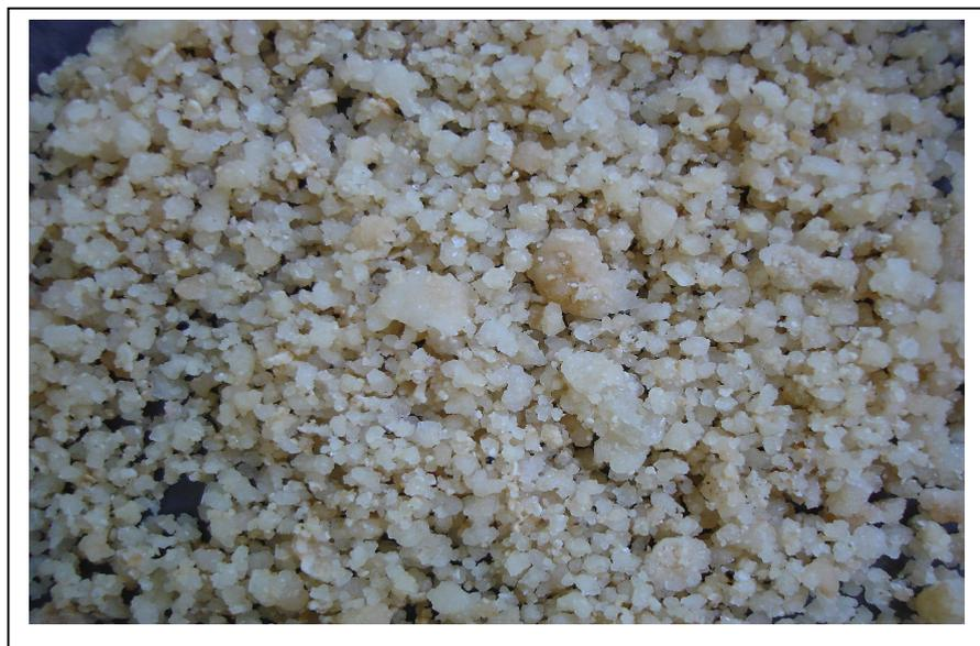
Figura 41. Muestra de sedimentos de evaporita perteneciente al ambiente hipersalino del cayo Francisquí Abajo. Los cristales son agregados de yeso y halita, lo que muestra las variaciones en la salinidad del ambiente y su influencia en la precipitación de uno u otro mineral. La precipitación de halita ocurre en momentos donde los valores de salinidad aumentan con respecto a los valores para la precipitación de yeso. Escala Horizontal: 4 cm.
