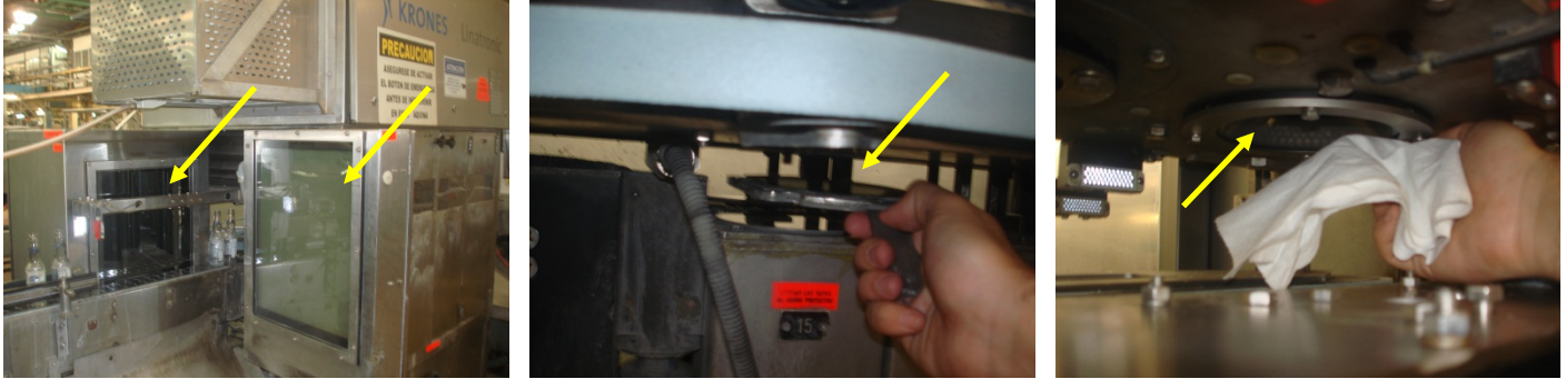
Foto 4. Vidrios protectores de Lámparas y Cámaras.
