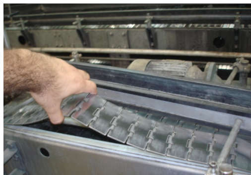
Foto 2. Levantamiento de un tramo de cadena de la vía.
