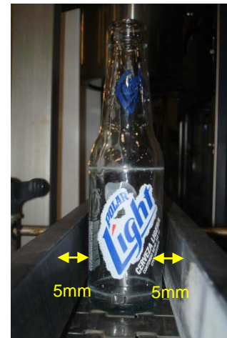
Foto 6. Separación entre botellas y baranda.
