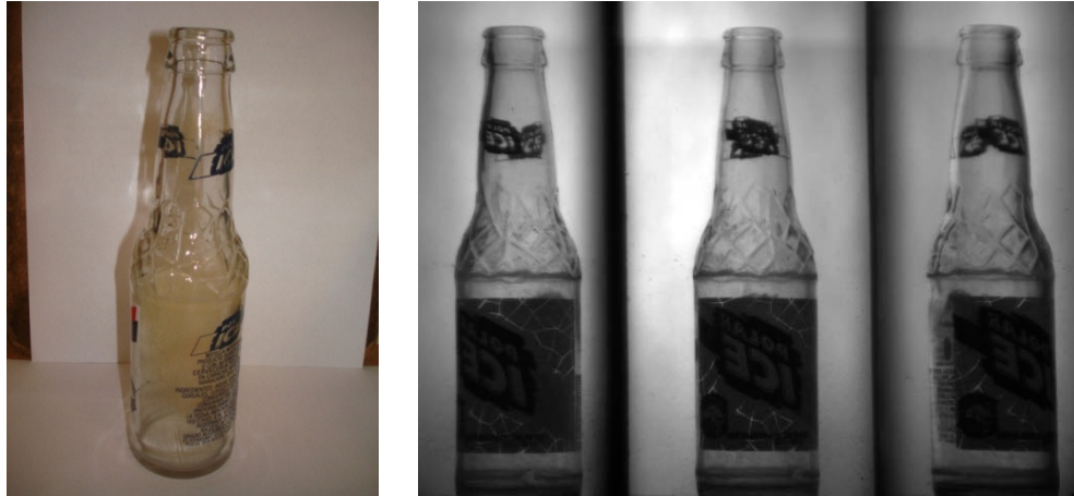
Figura 2.9. Botella con un sucio uniforme (Izquierda) y vista a través del inspector (Derecha).
