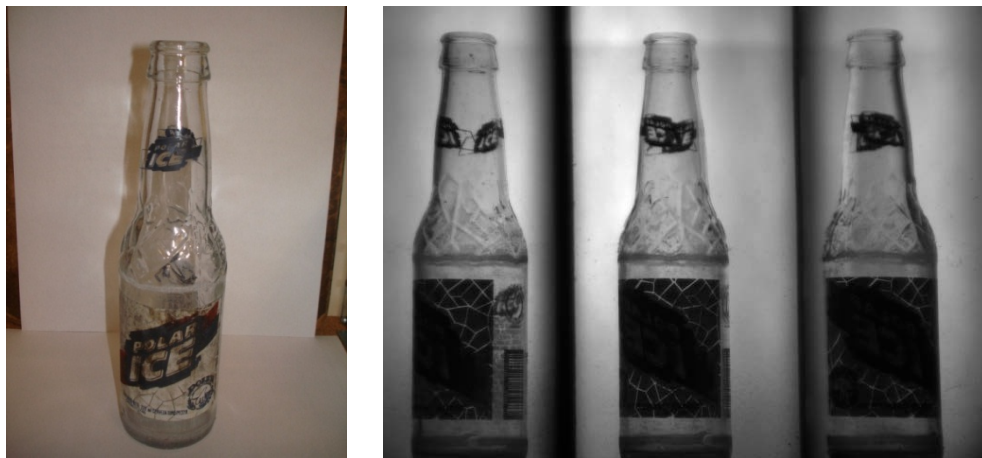
Figura 2.8. Botella con el logo inferior manchado (Izquierda) y vista a través del inspector (derecha).
