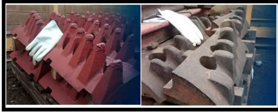
Figura 4.5.- Comparación de tamaño de los dientes antes y después de ser usados. Tomado de: Fuente propia 2011
