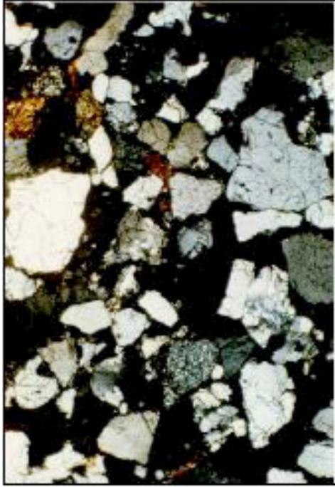
Fotomicrografía 6. Vista general de una arenita arcósica. Objetivo 2.50.12. Ocular 12.5X. Muestra 10.756'6''. Formación La Sierra.
