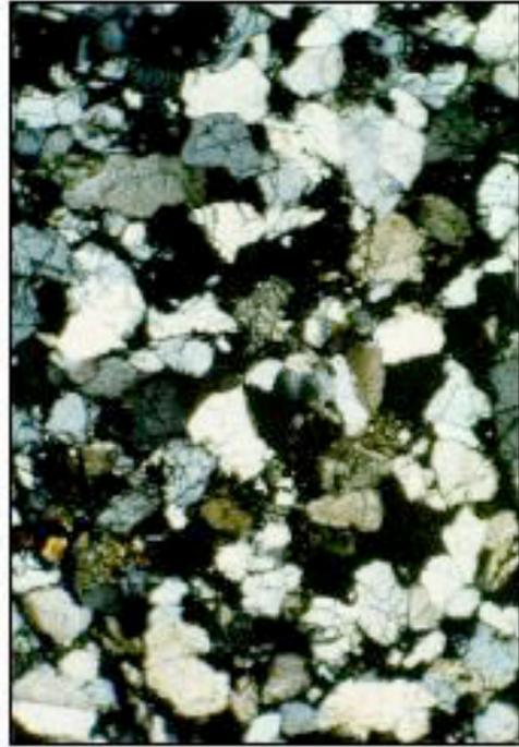
Fotomicrografía 7. Vista general de una Arenita Arcósica. Objetivo 2.50.12. Ocular 12.5X. Muestra 19. Formación Mirador
