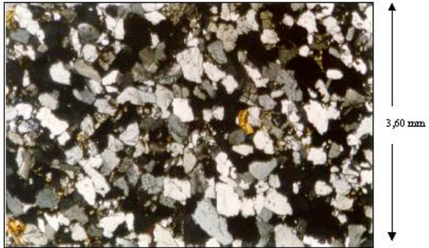
Fotomicrografía 11. Pueden notarse los fragmentos de rocas sedimentarias (lutitas), así como granos de chert, feldespatos y fragmentos de rocas ígneas volcánicas. Objetivo 2.5/0.8. Ocular 12.5 X. Muestra 10.792'7". Formación La Sierra. Arenita Lítica/Subarcosa
