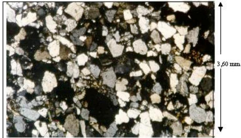
Fotomicrografía 16. En esta foto se pueden observar fragmentos de rocas metamórficas, ígneas volcánicas y sedimentarias (lutita). Objetivo 2.5/0.12. Ocular 12.5 X. Muestra 10.833'9''. Formación Mirador. Arenita Arcósica.
