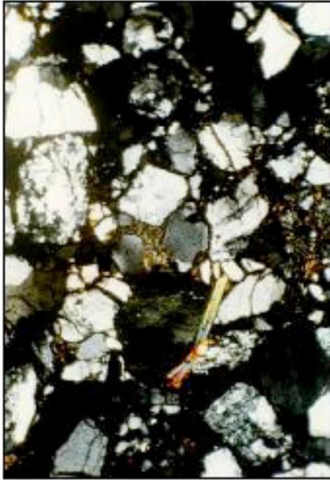
Fotomicrografía 5. Vista general de una arenita arcósica. Objetivo 2.50.12. Ocular 12.5X. Muestra 5. Formación Mirador
