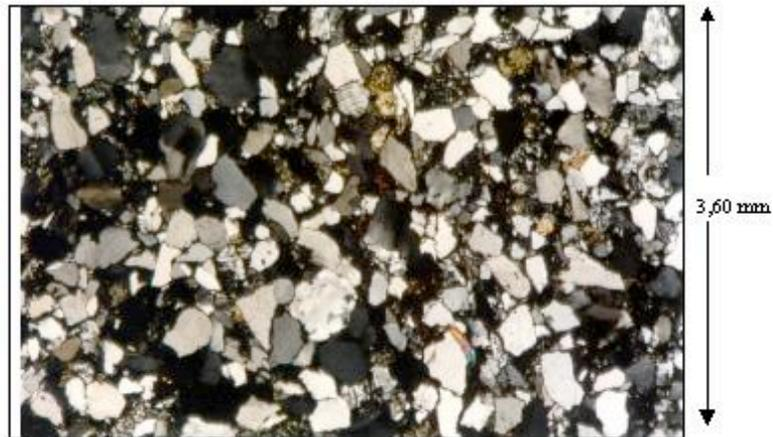
Fotomicrografía 15. Pueden notarse los granos de feldespatos, de chert, filosilicatos (muscovita principalmente) y cristales de cuarzo. Objetivo 2.5/0.8. Ocular 12.5 X. Muestra 10.853'9''. Formación Mirador. Subarcosa
