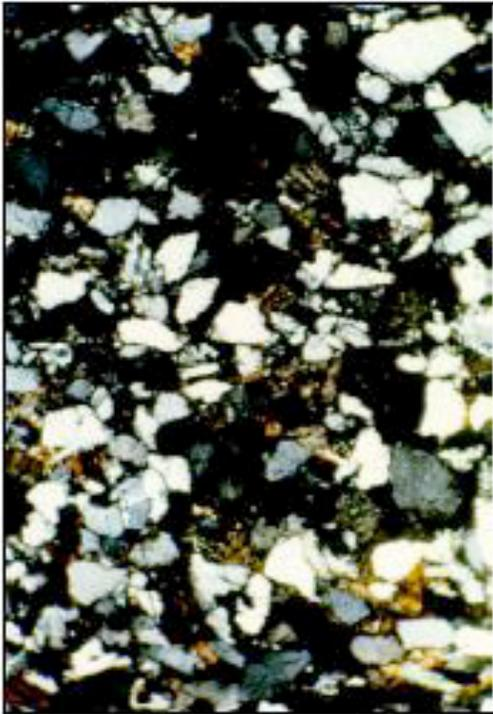
Fotomicrografía 1. Vista general de una arenita lítica/sublítica. Objetivo 2.50.12. Ocular 12.5X. Muestra 10.533'4''. Formación La Sierra.
