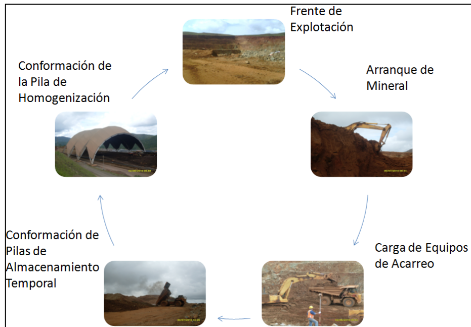
Figura 5.1. Representación Esquemática del Proceso de Extracción Mineral
