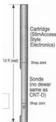
Fig 3.11. Herramienta neutrónica, soporta hasta 500 ° F de temperaturas y 30000 PSI de presión. Tomado de: [www.schlumberger.com](http://www.schlumberger.com)
