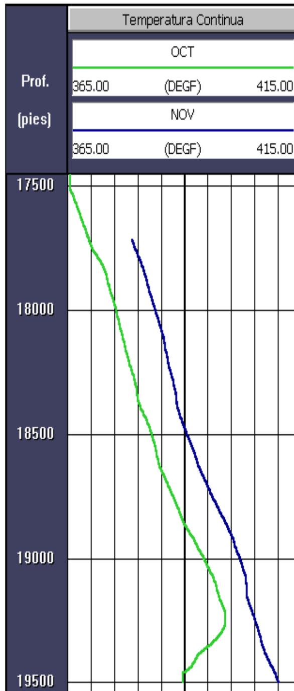
Fig 5.2 Curva de Temperatura continua en fechas diferentes.
