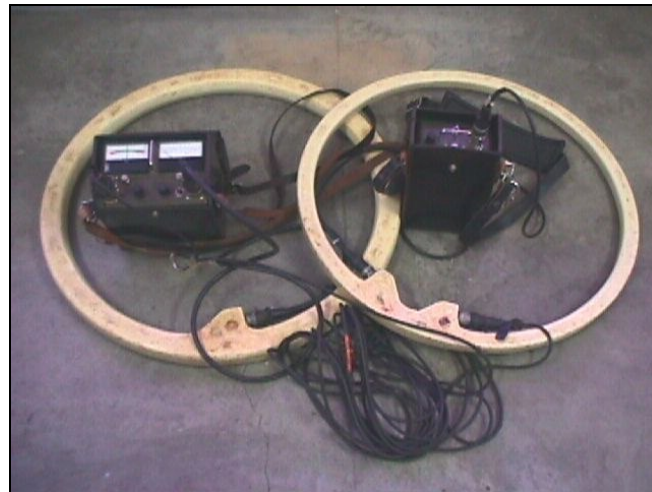
Figura 3.2.2 Equipo de electromagnético EM-34. Bobinas transmisoras y receptoras
