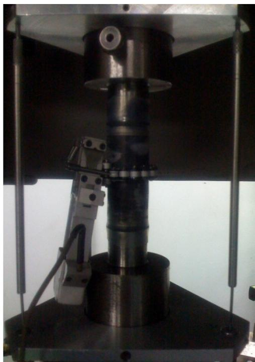
**Figura 55.** Preparación de los ensayos uniaxiales
