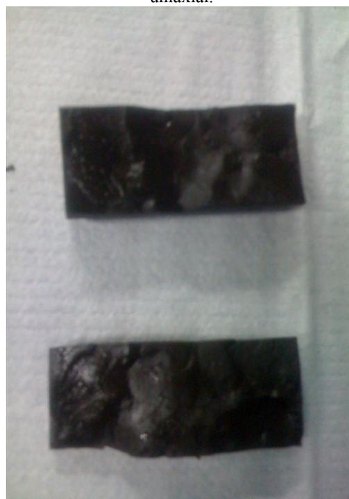
**Figura 60.** Tapón horizontal luego del ensayo uniaxial.
