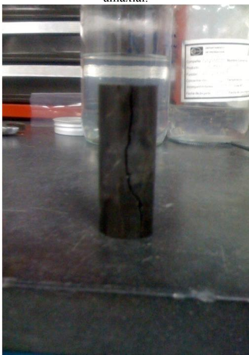
**Figura 59.** Tapón horizontal luego del ensayo uniaxial.
