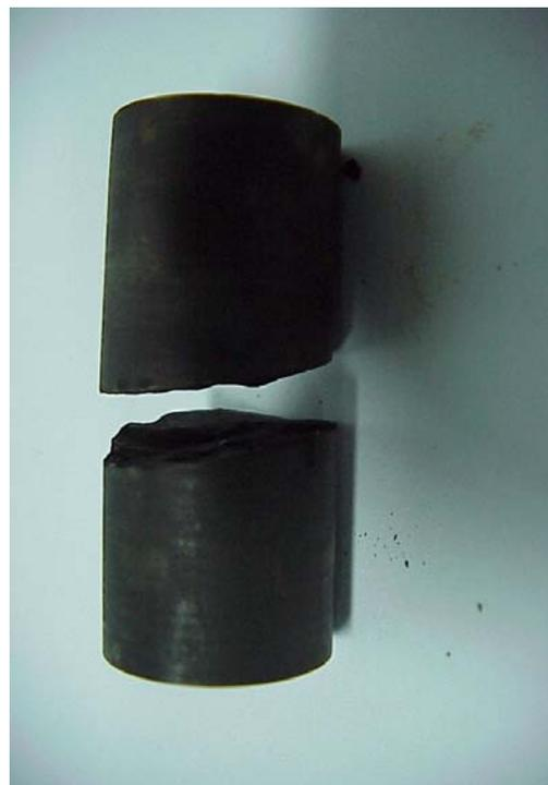
**Figura 58.** Tapón vertical luego del ensayo uniaxial.
