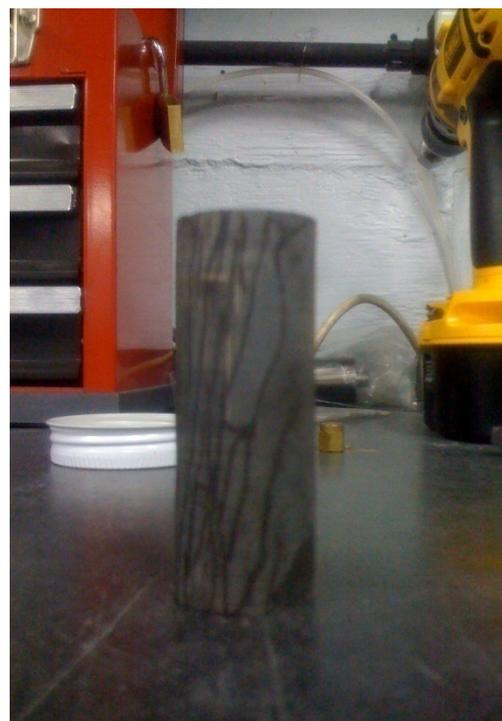
**Figura 52.** Tapón horizontal luego de la interacción con KCl 2%
