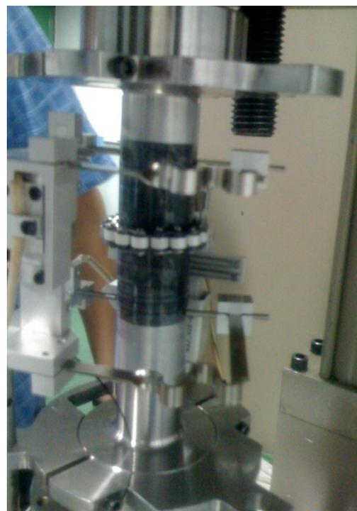
**Figura 56.** Tapón en celda uniaxial
