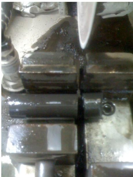
**Figura 47.** Proceso de corte de los tapones a las dimensiones requeridas
