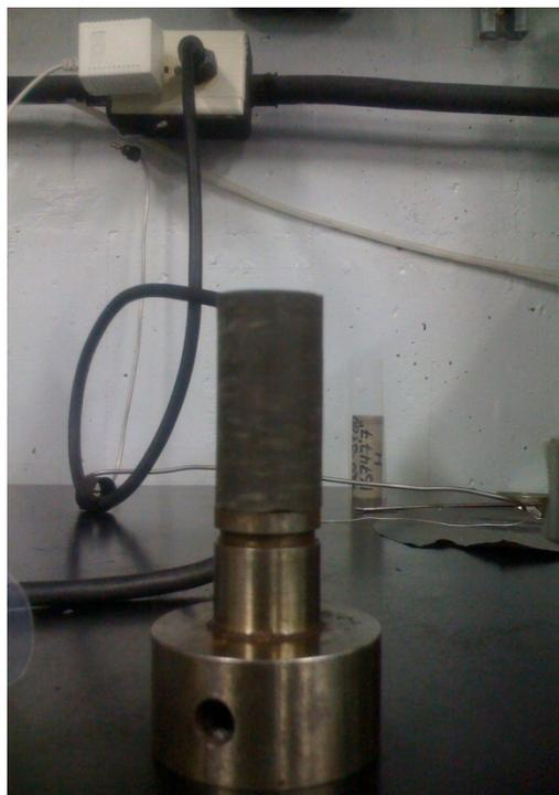
**Figura 53.** Tapón vertical antes de ser ensayado en la celda uniaxial
