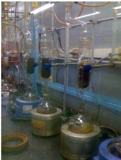
**Figura 45.** Lavado de las muestras previo a los ensayos petrográficos.
