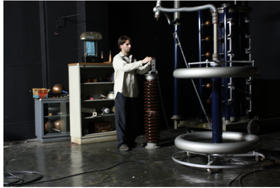
(a) Conexión del alambre a la salida del generador Marx ajustado a una etapa.
