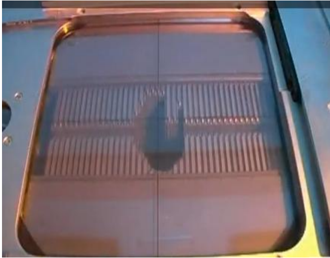
Figura N° 26: Colimador Multiláminas (vista lateral)
