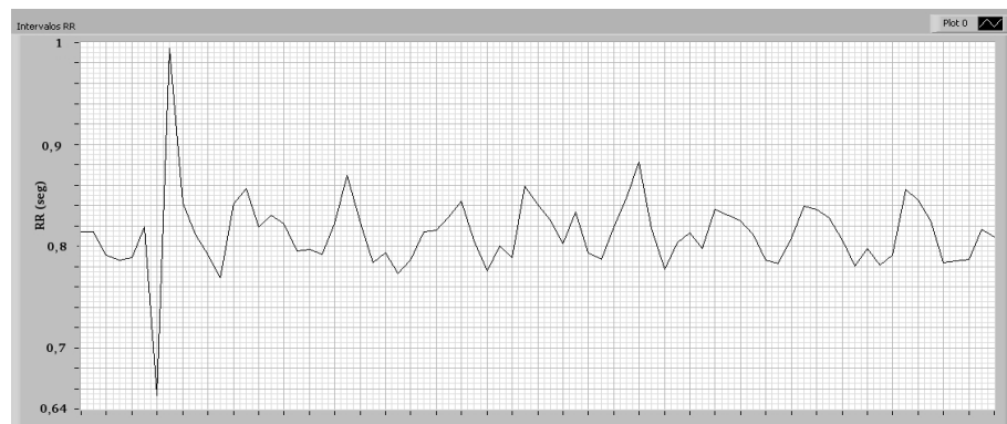
Figura 4.9: Intervalos RR del registro #100 según el instrumento virtual
