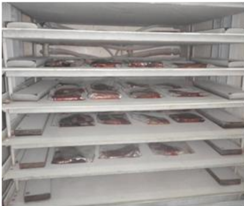
Figura 3.- Rebanadas de lomo de atún en bolsas de PEBD sobre las placas del congelador marca DOLE®.
