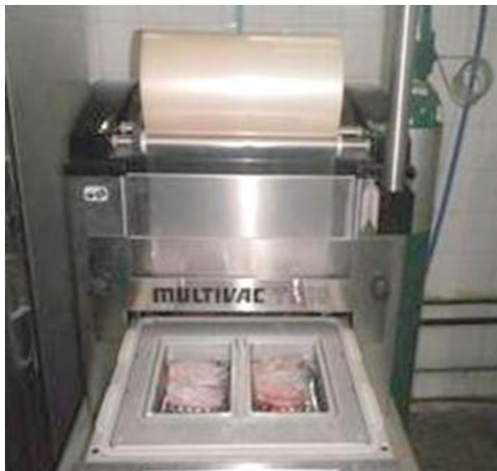
Figura 4.- Operación de empacado de rebanadas de atún, en termoselladora MULTIVAC T200.
