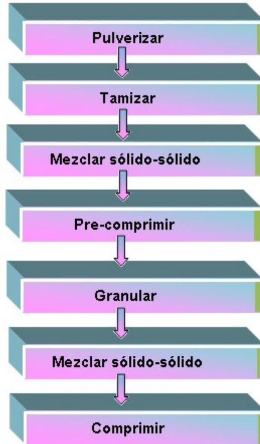
**Figura 3.** Operaciones unitarias involucradas en la fabricación de tabletas comprimidas por el método de granulación seca
