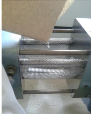
**Figura 17.** Proceso de granulación
