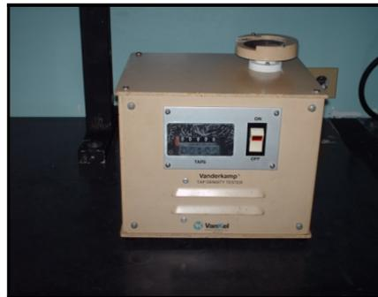
**Figura 12.** Densitómetro de compactación Vanderkamp Tap Density Tester® Tomado del laboratorio de la Mención de Tecnología Industrial Farmacéutica. UCV
