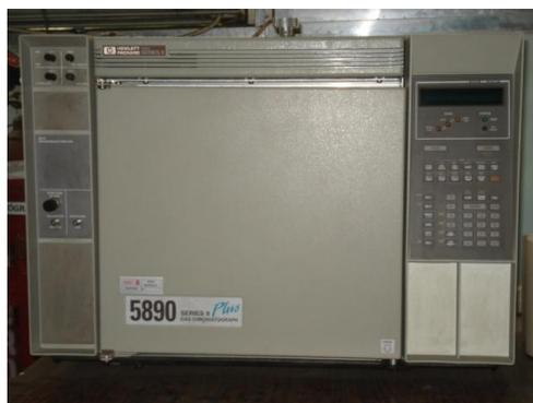
**Figura 5.8.-** Cromatógrafo de gases HP GC 5890 Series II.
