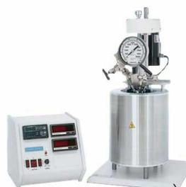
**Figura 5.1.-** Montaje completo para un reactor Parr donde se observa el reactor dentro del horno junto al controlador de temperatura del sistema <sup>[39]</sup>.
