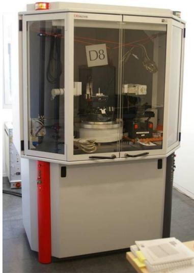
**Figura 5.3.**- Difractómetro de rayos X marca Bruker AXS modelo D-8 Discover.
