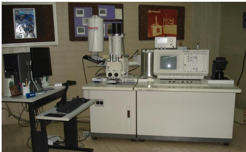
**Figura 5.4.**- Microscopio electrónico de barrido.
