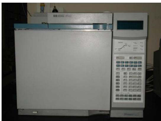
**Figura 5.6.-** Cromatógrafo de gases HP GC 6890.
