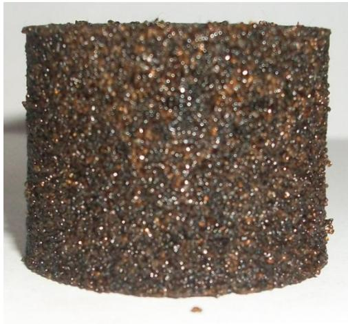
**Figura A.6** Muestra de núcleo saturada con crudo
