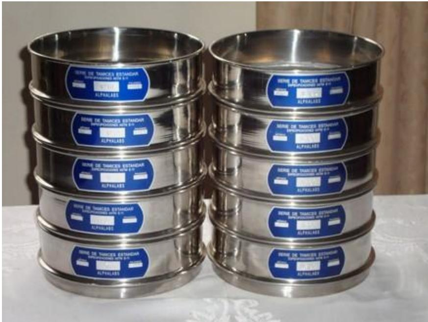
**Figura III.2 Tamices que se emplean en para el Análisis Granulométrico**
