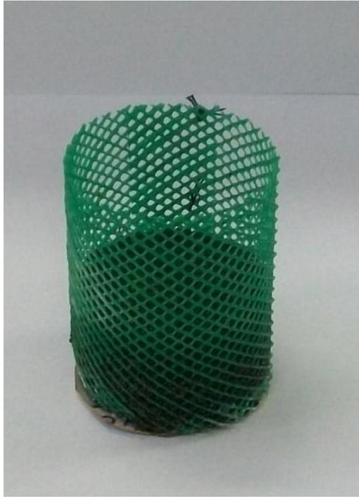
**Figura A.7** Muestra de núcleo saturada protegida con malla plástica
