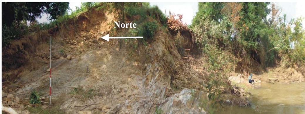
**Figura 2.10** Composición fotográfica de un afloramiento lutítico (RMR Clase III) del miembro Revoltijo Fm Quiamare, en el cauce del Río Querecual en el vaso de la presa. La escala es el bastón topográfico (izq) en el que cada sección roja equivale a 0,30 m. Modificado FLNH (2010).
