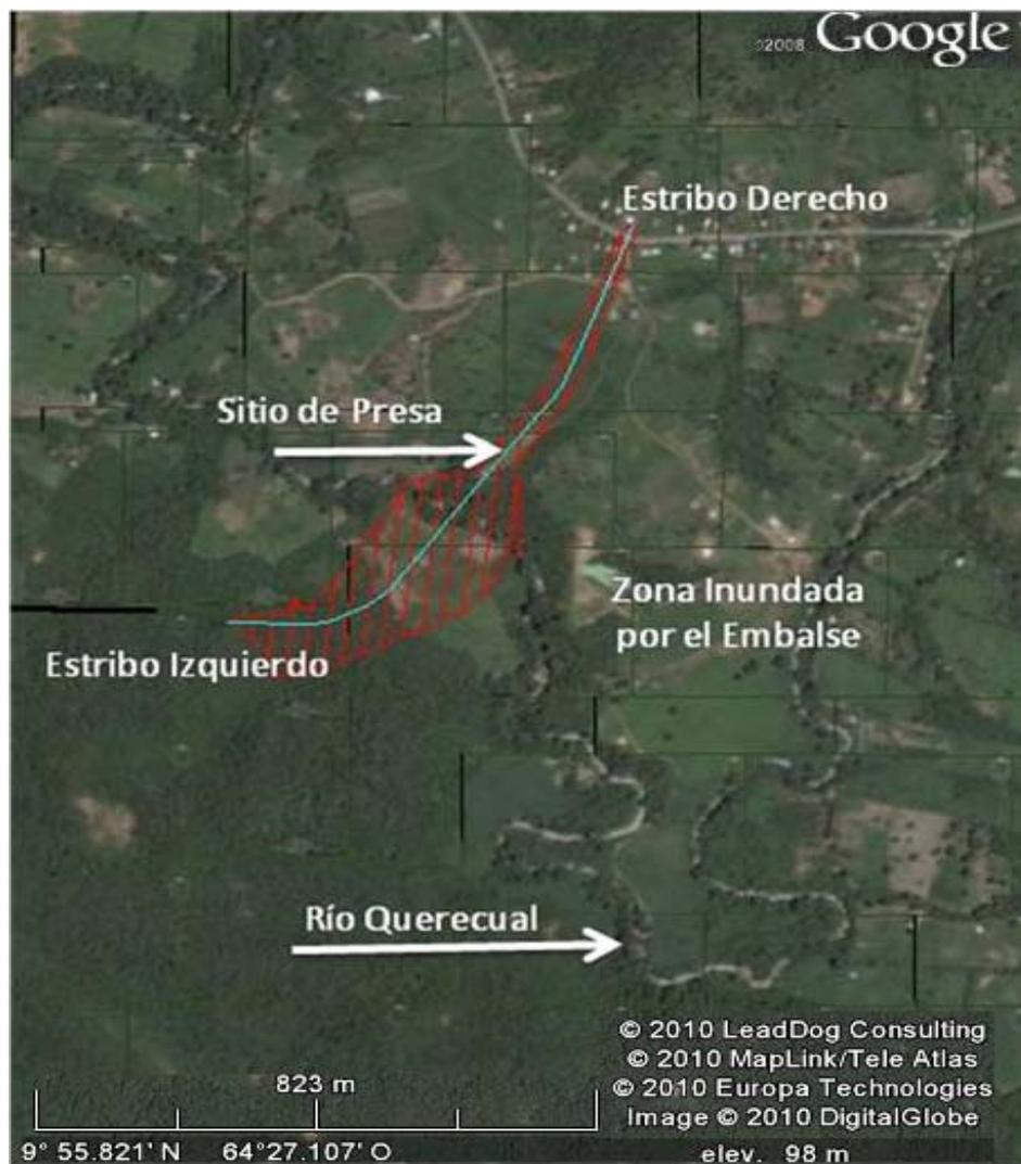
**Figura 2.2** Foto satelital del sitio de ubicación de la presa, donde se ha diagramado el eje de la presa, los estribos y parte del embalse. Modificado de FLNH (2009).
