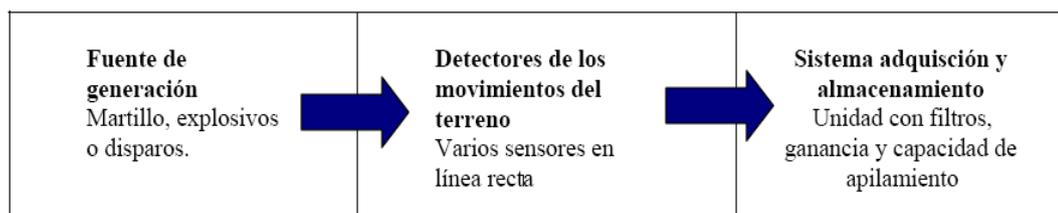
**Figura 3.2** Esquema general del equipo de refracción sísmica. (Martín, 2008).
