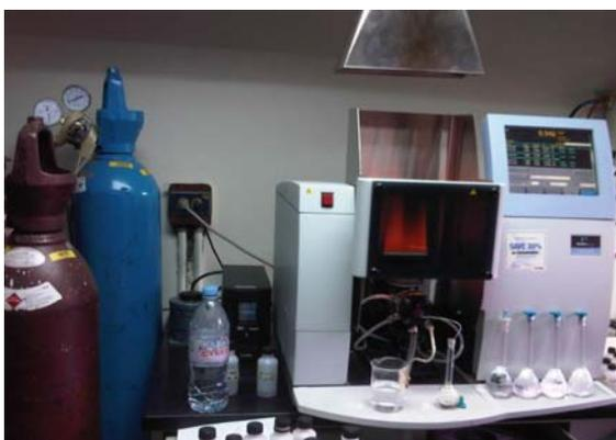
**Figura 24:** *Espectrofotómetro atómico Perkin Elmer analist 200*
