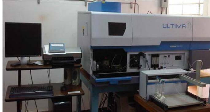
**Figura 25:** *Equipo de emisión atómica con fuente de plasma de acoplamiento inductivo marca Horiban Jobin, modelo Xwn AS 500*
