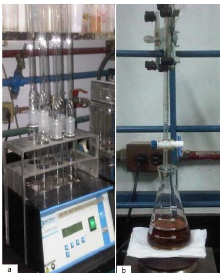
**Figura 28:** a. Equipo de reflujo abierto. b. Coloración de punto final de titulación con sulfato ferroso amoniacal utilizando como indicador ferroína
