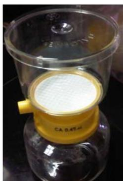
**Figura 23:** Equipo de filtración al vacío con membrana de 0,45 $\mu\text{m}$ .
