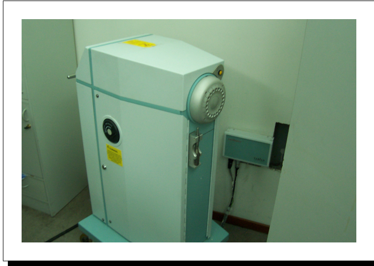
Figura 1.8: Base móvil de un equipo de braquiterapia de alta tasa de dosis, “Varis Source®”.
