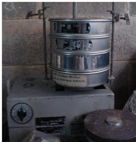
**Figura 6.23.** Agitador de tamices
