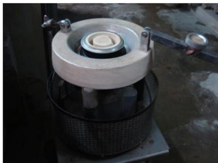
**Figura 6.21.** Pulverizadora de muestra Chaterbot
