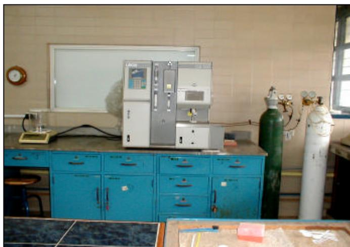
Figura IV.12- Analizador de Carbono LECO C – 200.
