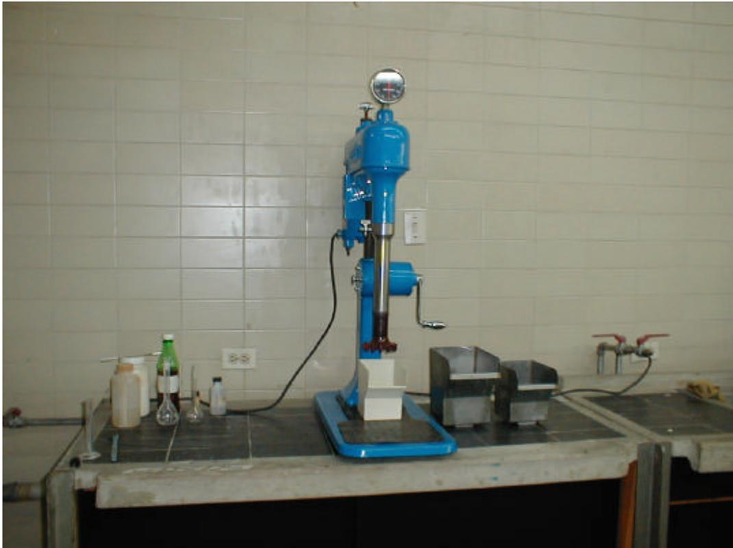
**Figura VI.1 Celda aislada de flotación Denver.**
