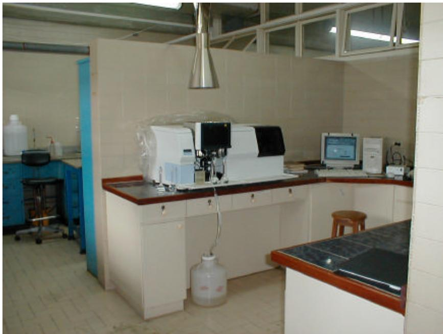
**Figura IV.10 Espectrofotómetro de absorción atómica.**
