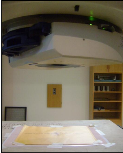
Figura 4. 2: Colocación de película radiográfica para verificación del isocentro de rotación del mMLC
