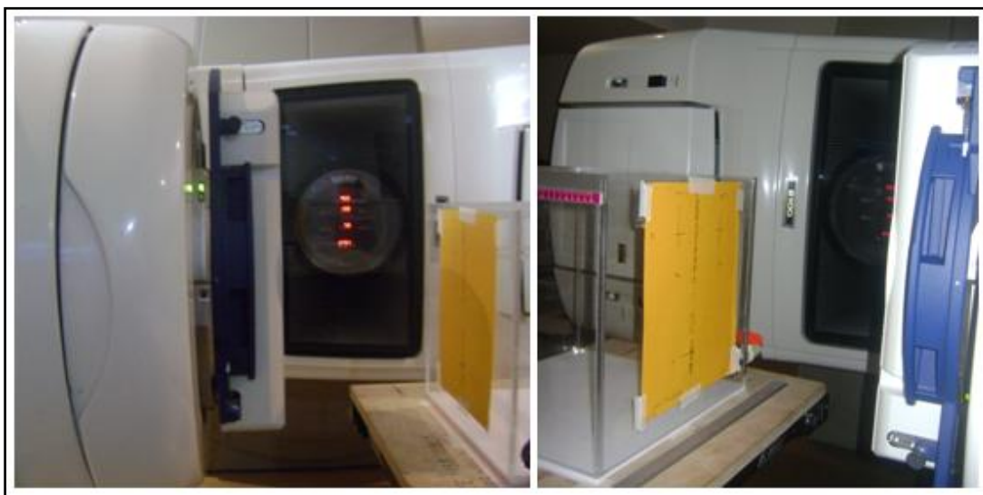
Figura 4. 11: Angulaciones del gantry para la verificación de Ortogonalidad de las láminas respecto a las mandíbulas
