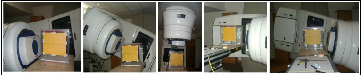
Figura 4. 3: Angulaciones del gantry para verificación del isocentro de rotación
