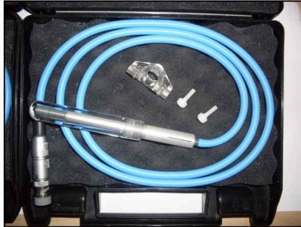
Figura 3. 7: Cámara de ionización tipo FARMER con su caperuza de equilibrio y soporte para posicionamiento en el sistema TBA
