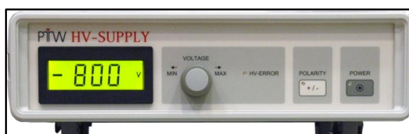
Figura 3. 14: Fuente externa de alto voltaje (PTW - Freiburg)
