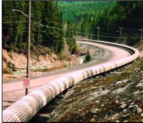
Figura 4.29. Correa transportadora con curvas horizontales
