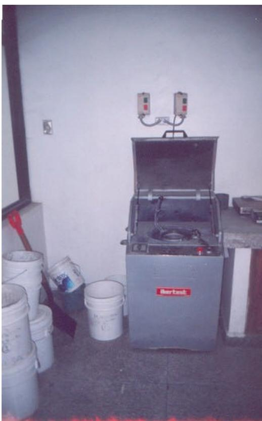
**Figura 3.13.- Molino vibratorio. Marca Ibertest**
