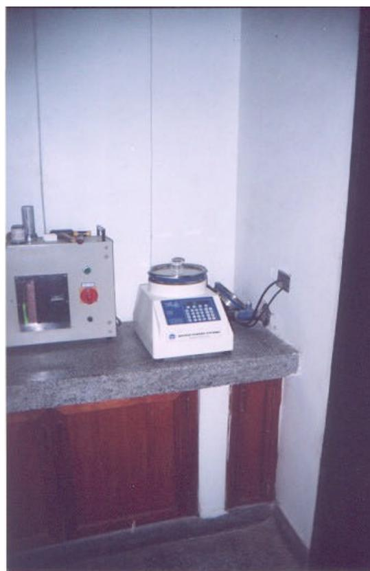
**Figura 3.14.- Tamizador electrónico marca Micron Powder Systems**
