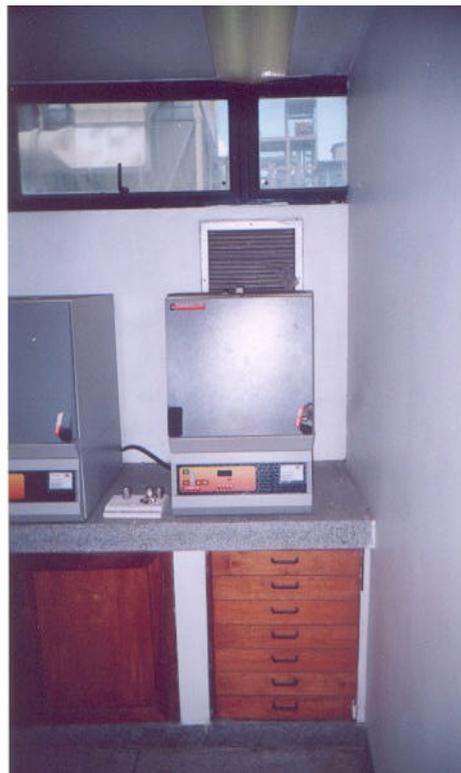
**Figura 3.16.- Mufla marca Carbolite modelo RHF 15/8**
