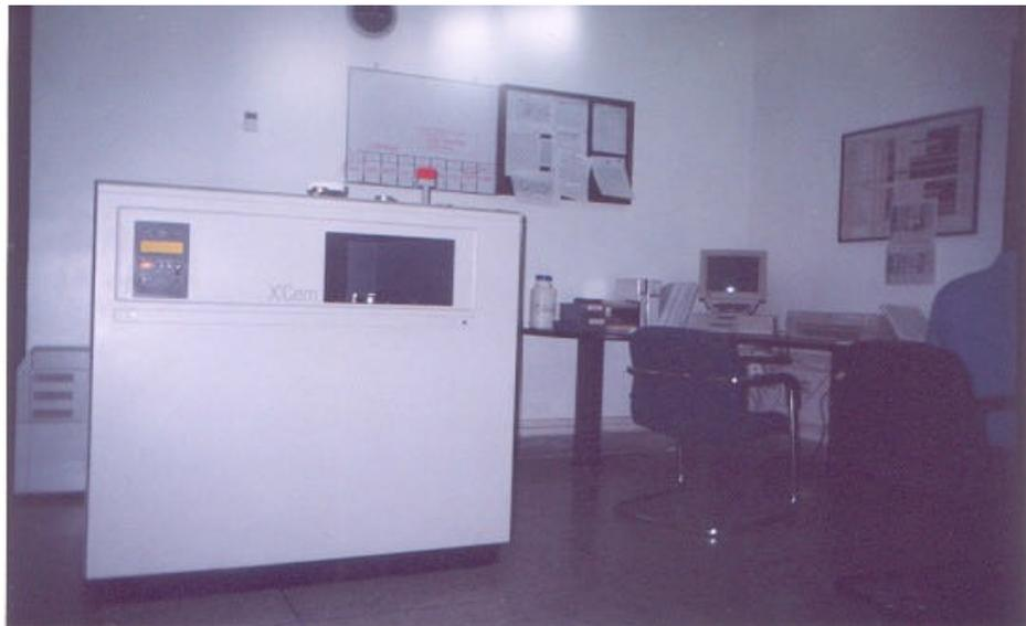
Figura 3.11.- Espectrómetro de Rayos X, , modelo X–CEM, fabricado por la PHILLIPS
