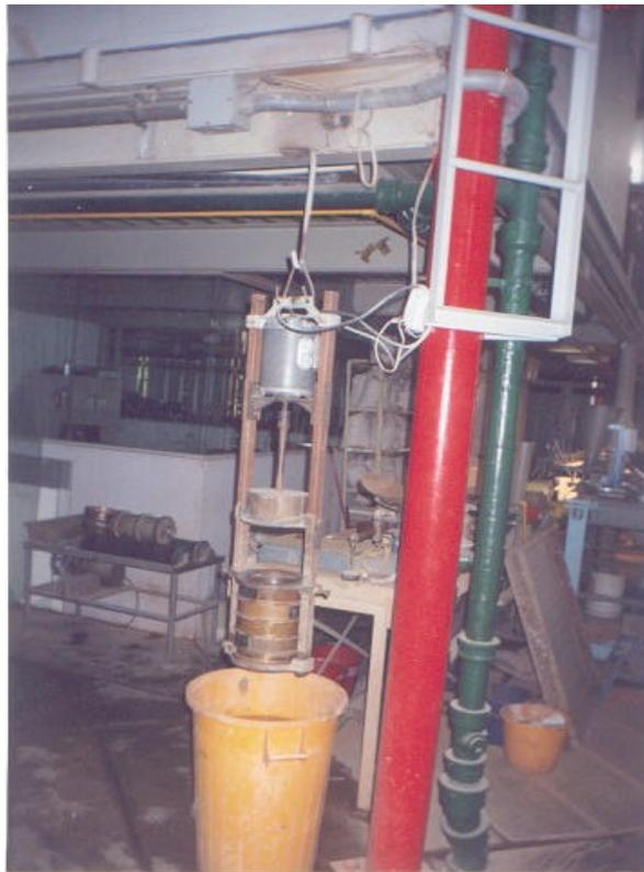
**Figura 3.1.- Rot Tap colgante para el deslamado de la muestra**
