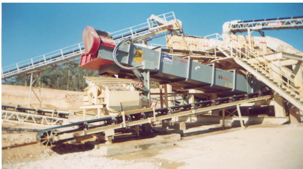
**Figura 1.5.- Tornillo Lavador de donde proviene el material de la Banda # 2**
