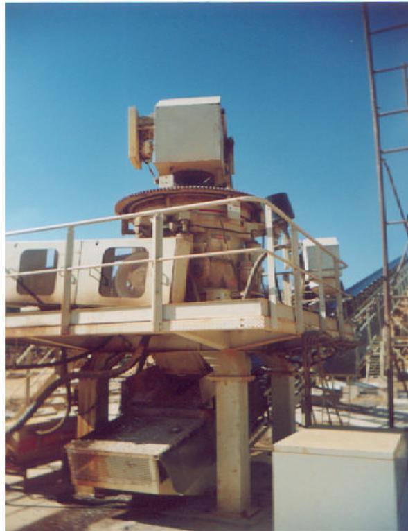
**Figura 1.7.- Cono Nordberg, donde llega el material proveniente de la Banda # 7**
