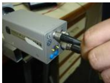
Figura N° 16. Conexión del cable de poder a la cámara captadora de imágenes.
