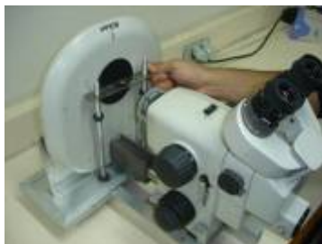
Figura N° 6. Colocación de la base móvil.
