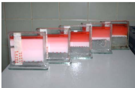
Figura N° 27. Separación de la emulsión sintética W/O bajo la aplicación de 60, 300, 900, 1800 y 3600 segundos respectivamente de campo eléctrico DC a un voltaje de 2,00kV.
