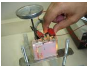
Figura N° 7. Ajuste de los cables de la fuente de poder a los electrodos.
