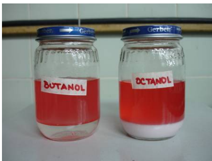
Figura N° 19. Separación de fases observada en las emulsiones preparadas con N-40 como surfactante y butanol u octanol como co-surfactante respectivamente.
