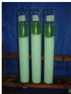
Figura N° 20. Separación de fases observada en las emulsiones preparadas con Span-80.
