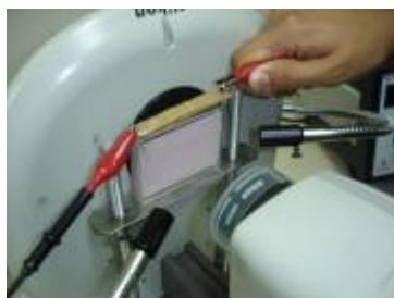
Figura N° 11. Ajuste de cables de la fuente de alto poder a los electrodos.
