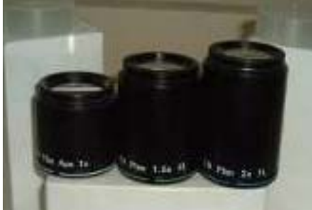
Figura N° 23. Objetivos que integran el equipo de visualización del Microscopio Estereoscópico Nikon SMZ-U (1X, 1.5X y 2X de izquierda a derecha).
