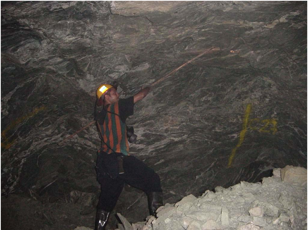
Figura 5. 8 Minero en proceso de acuñamiento de techo
