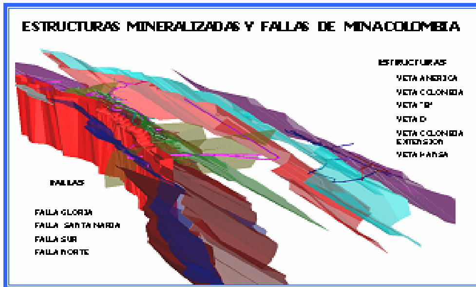
Figura 2. 5 Estructuras mineralizadas y fallas de la mina Colombia
