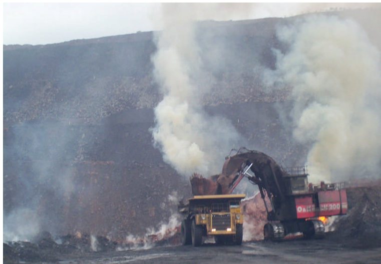
Figura 17. Imagen del nivel -36 (zona 2), hacia el Norte del grupo 6. Se observa como se remueve el material en llamas.
