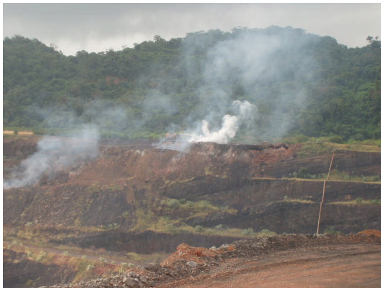
Figura 15. Imagen mostrando zona perimetral Sur, donde observamos la autocombustión de la Zona 1
