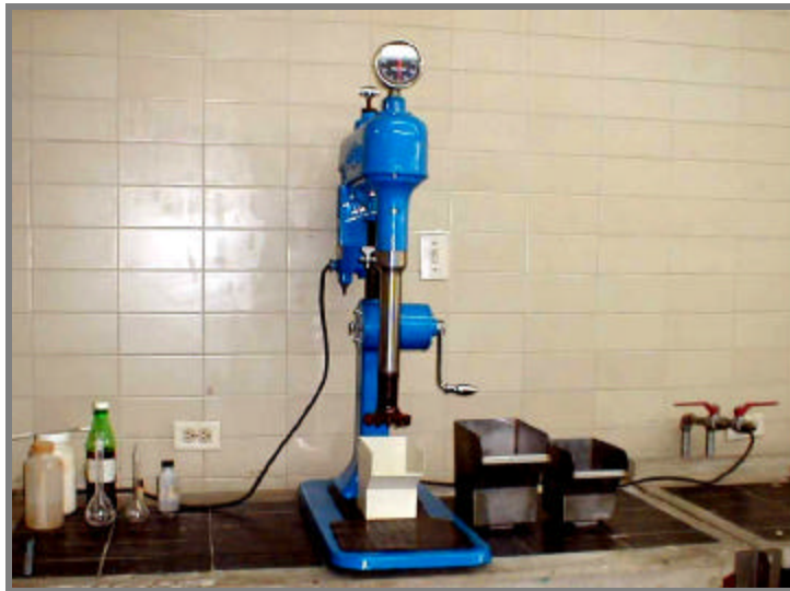
Fig. 22. Celda Convencional Denver de Laboratorio
