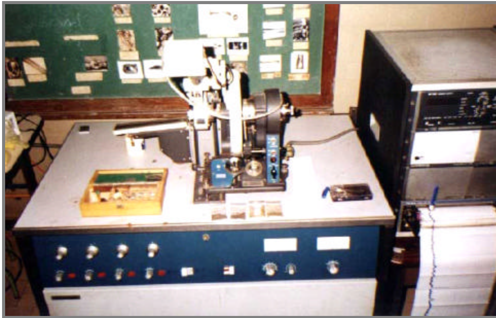
Fig. 17. Difractómetro de Rayos X
