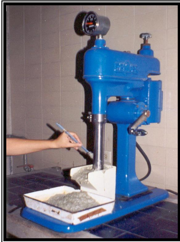
Figura 19. Máquina de flotación (Denver, D-12).
