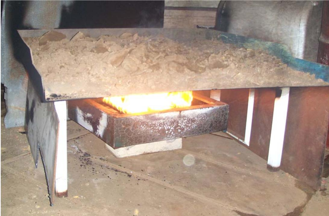
Figura 21. Secado de la muestra de suelo grafitoso sobre una plancha metálica.
