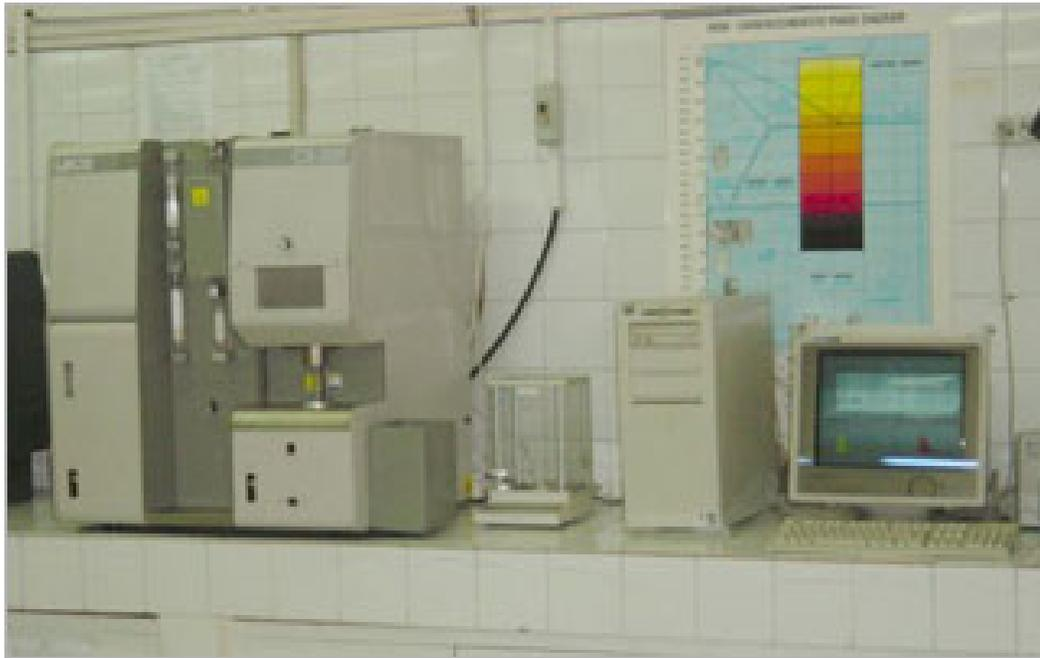
Figura 29. Ejemplo de un equipo Analizador de Carbono Leco CS-200.
