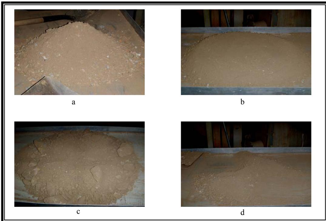
Figura 23. Muestreo manual, cono y cuarteo, del material mineralizado.
