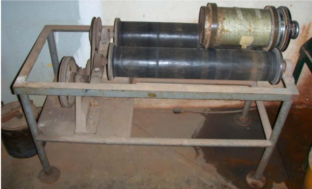
Figura 28. Molino de barras y bancada Galigher utilizados en el laboratorio.
