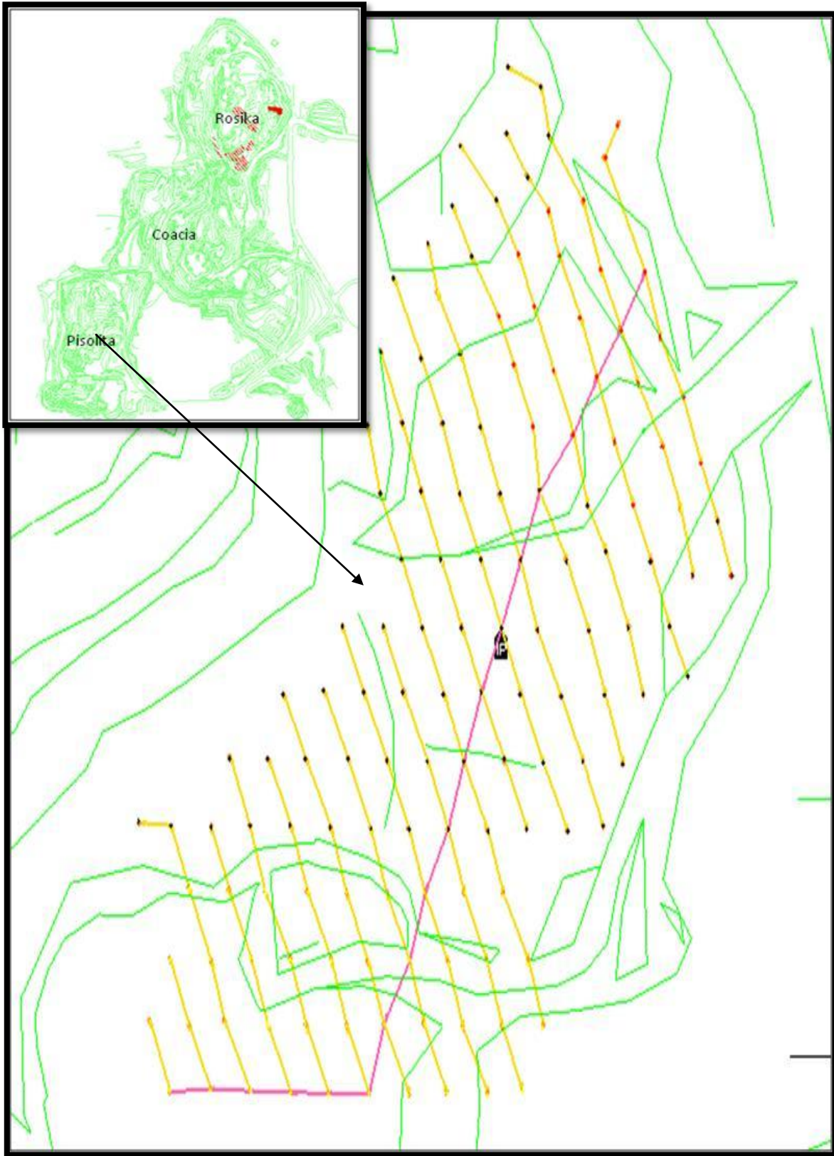
Figura N° 46 Ubicación, Diseño de perforación y encendido de la voladura N°28(Fuente P.M.G)
