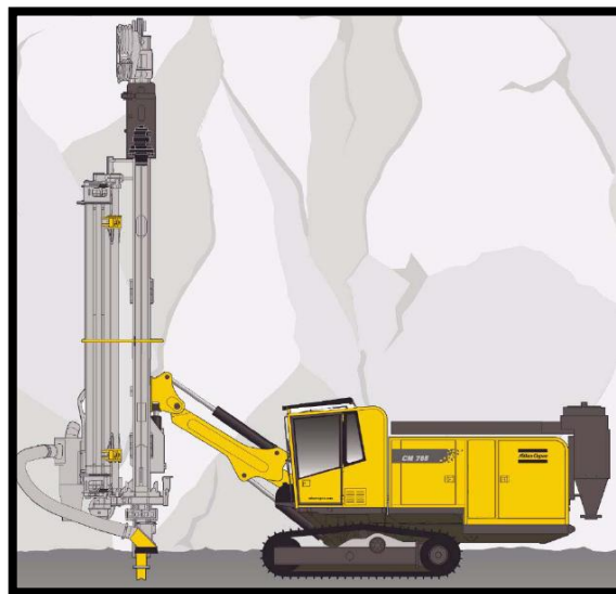
Figura N° 15 Perforadora Rotopercutiva con Martillo en Fondo (Manual CM-785 Atlas Copco)
