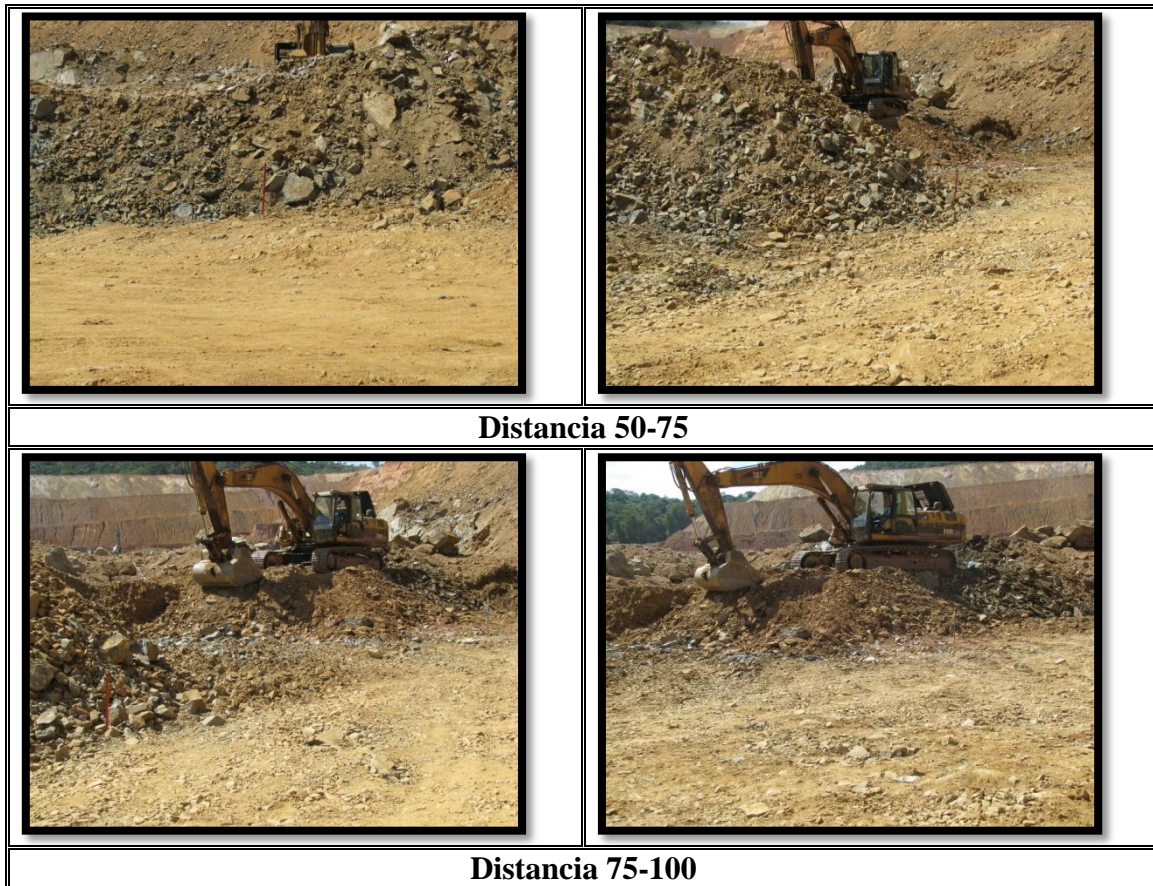
Figura N° 58 Secuencia de Evaluación por Tramo Voladura N° 34 (Fuente Propia)
