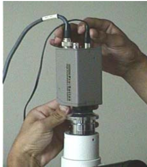
Figura B-1. Posición de la base de la cámara en el microscopio.
