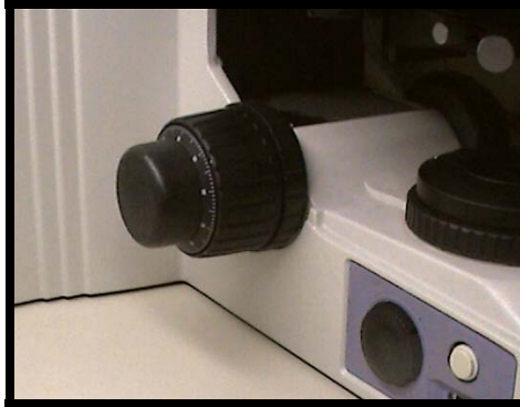
Figura N° 31. Tornillo micrométrico y macrométrico del microscopio Nikon MED-600
