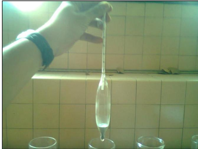
**Figura 4.7. Hidrómetro 152H**
