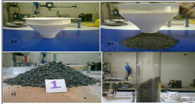
**Figura 4.19. a) Cono de plástico usado para el ensayo de cono; b) Vertido de material a través del cono; c) Pila formada al verter el material; d) Cilindro utilizado para realizar ensayo**
