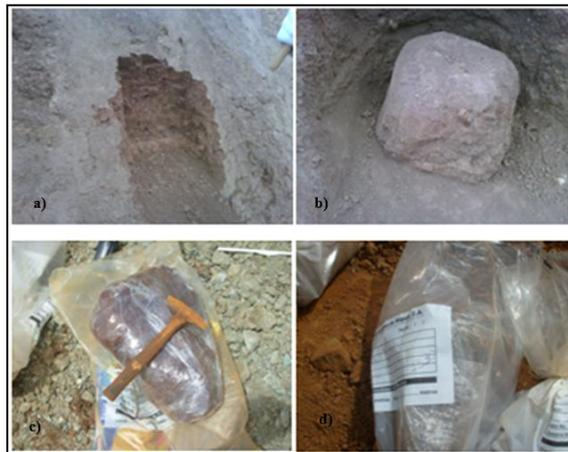
**Figura 4.10. a) Apertura inicial en el talud; b) Bloque o monolito cortado en el talud; c) Monolito sellado en papel plástico; d) Monolito dentro de una bolsa de muestreo**
