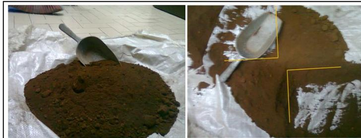
**Figura 4.12. Izquierda: Material a reducir por cono y cuarteo en una lona. Derecha: Cuarteo de material removiendo áreas opuestas en la torta de material**
