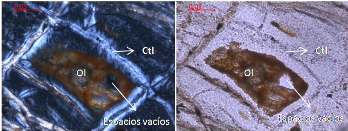
**Figura 5.24. Textura mesh característica. Fotomicrografías NP (izq.) y NC (der.)**
