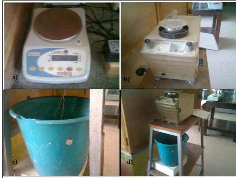
**Figura 4.8. a) Balanza analítica Setra; b) Balanza Metter; c) Envase plástico con agua incorporado a la balanza metter; d) Conjunto balanza y envase plástico para pesar elementos en medios líquidos**
