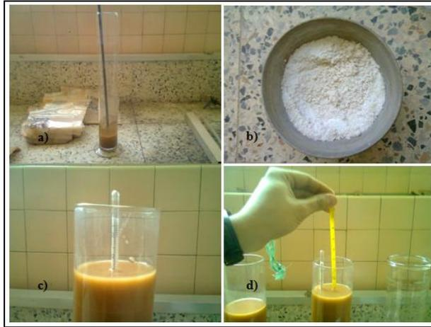
**Figura 4.15. a) Cilindro con fracción de suelo y floculante; b) Floculante; c) Hidrómetro; d) Termómetro**
