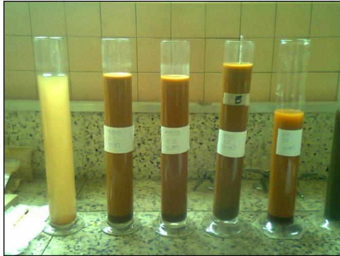
**Figura 4.6. Cilindros para ensayo con Hidrómetro**
