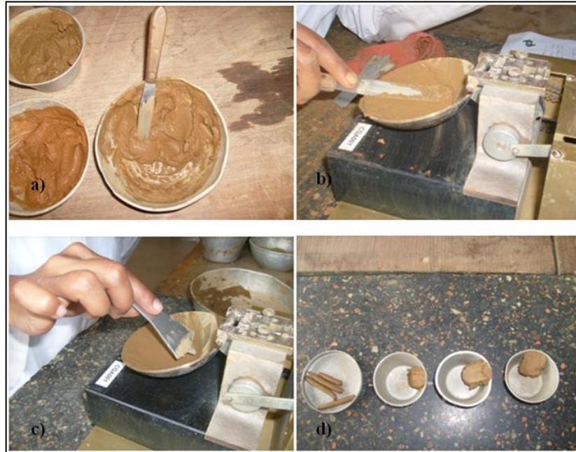
**Figura 4.16. a) Mezcla de agua con el material pasante de la malla N° 40; b) Material en la copa de Casagrande; c) Apertura del material en la copa de Casagrande; d) Muestras de material de la fracción colapsada**
