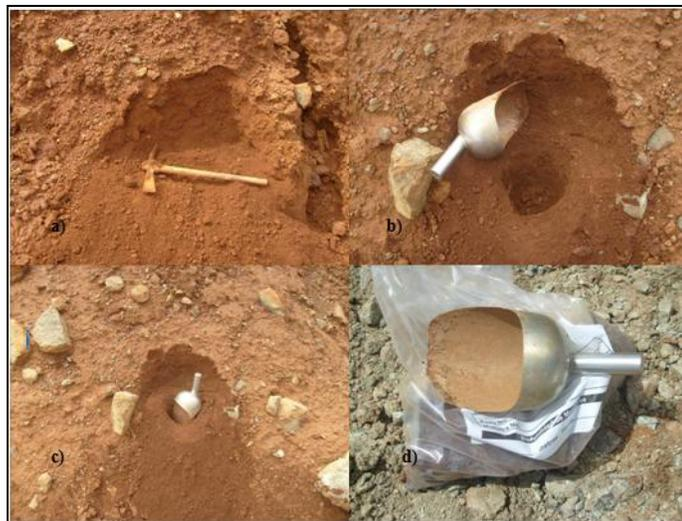
**Figura 4.11. a) Apertura inicial en el talud de la escombrera; b) Apertura profunda; c) Extracción de muestra puntual; d) Muestra puntual en bolsa plástica**
