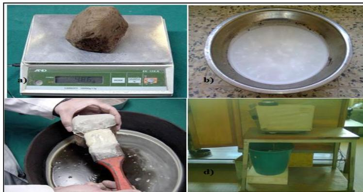
**Figura 4.18. a) Muestra de material; b) Parafina; c) Muestra parcialmente cubierta con parafina; d) Conjunto de balanza y envase para pesar la muestra en agua**
