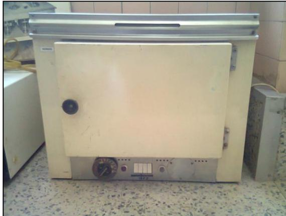
**Figura 4.5. Horno Memmert para secado de muestras**
