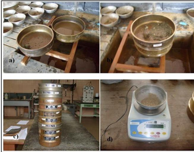
**Figura 4.13. a) Tamices malla número 100 y 200; b) Lavado de muestra, eliminando el pasante de la malla número 200; c) Batería de tamices desde 2" hasta número 200; d) Peso de retenido en un tamiz**
