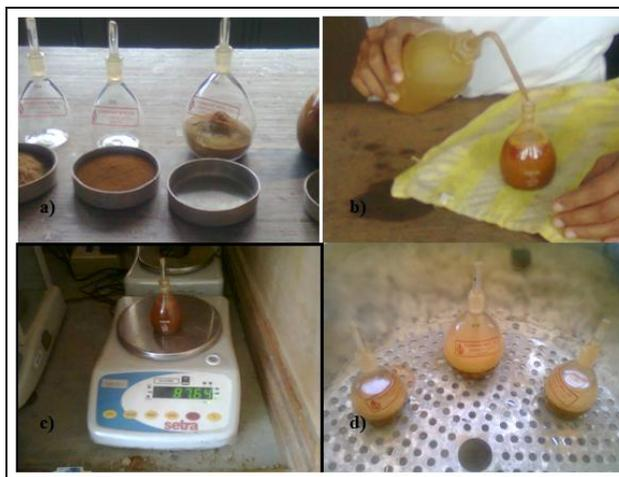
**Figura 4.14. a) Picnómetros con muestras de suelo; b) Llenado parcial de picnómetros; c) Peso de picnómetros con pulpa de suelo; d) Picnómetros en la cámara de vacío**
