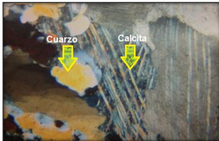
Figura 29. Muestra 1. Fotomicrografía Nícoles cruzado.
