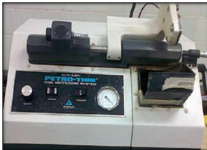
Figura 11. Foto de Desbastadora cortadora marca Petro-Thin. Fuente: Propia (2013)
