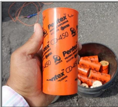
**Figura N°23.** Apariencia física del booster de pentolita.
