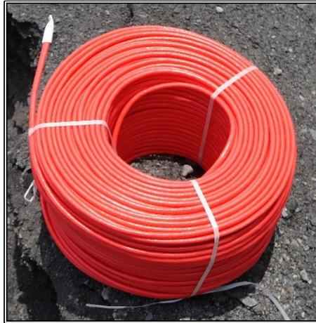
**Figura N° 22.** Apariencia física del cordón detonante.
