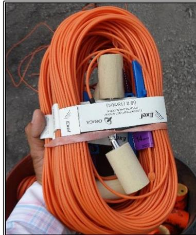
**Figura N°25.** Apariencia física del detonador no eléctrico de retardo (Nonel).
