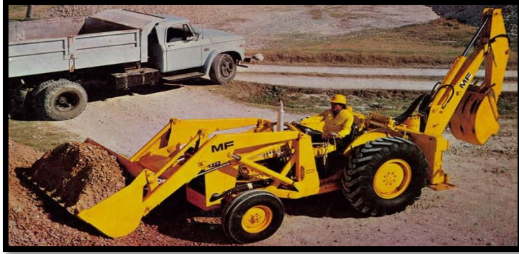
Figura 9. Cargador Retroexcavador MF65 Fuente: www.masseyferguson.com.ar (fecha de consulta 27/02/2014)
