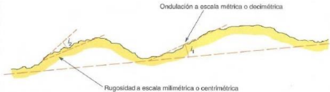
Figura 14. Ondulación y rugosidad de una superficie de discontinuidad (Gonzales de Vallejo, 2002)
