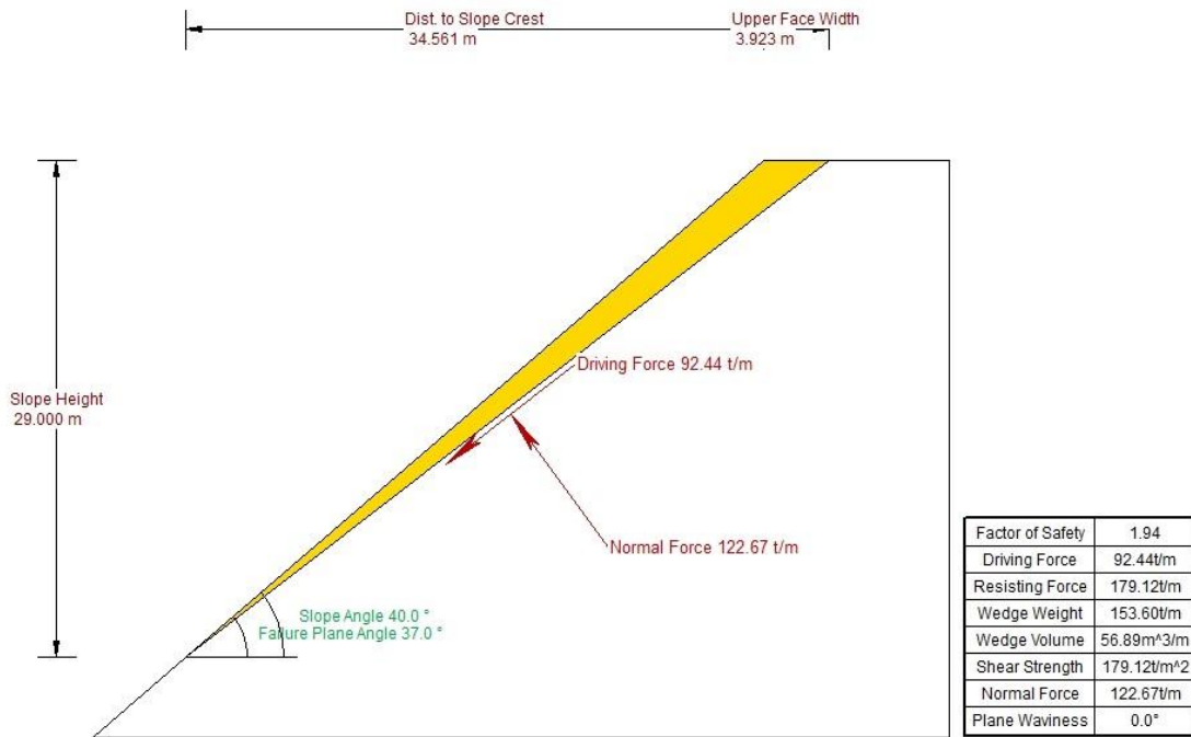
Figura 54. Configuración del talud y resultados del análisis mecánico de la falla plana de la zona 2-R
