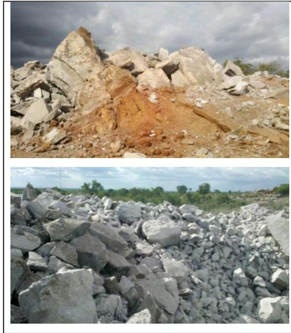
Figura 14: Evaluación del sobretamaño Constructora Pedeca C.A. Bolívar
