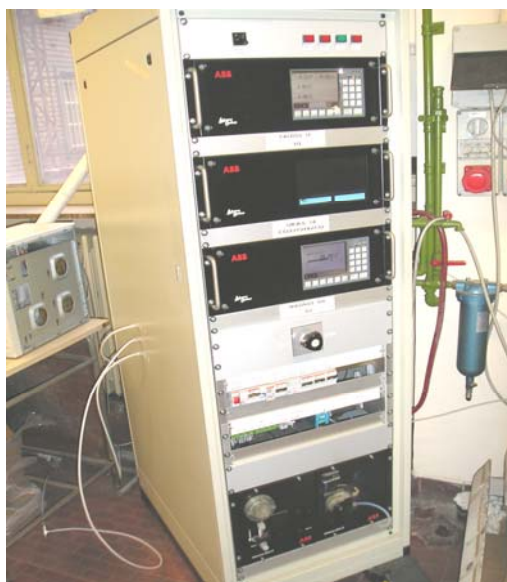
Figura 6.9: Fotografía del analizador utilizado (ABB Instrumentation S.p.A Hartmann & Braun)
