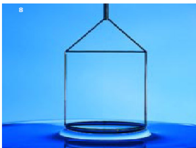
Figura 12: Dispositivo para medir la tensión superficial según el método del anillo (Du Nouy)
