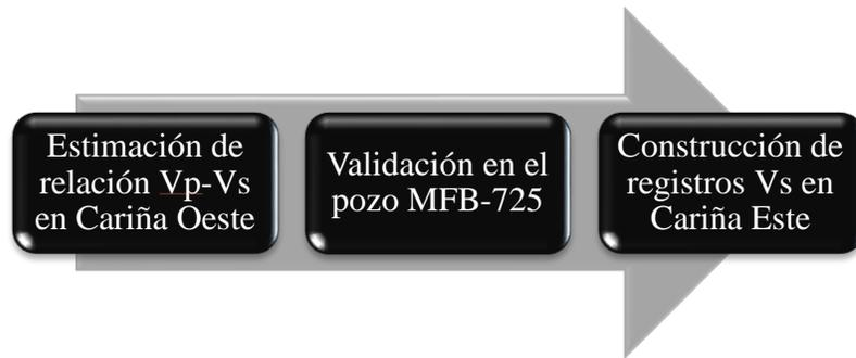
Figura 4.6: Esquema de estimación de la relación Vp-Vs en los Campos Cariña y Bare
