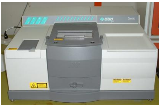
Figura N°16. Espectrómetro NICOLETTE Magna-IR 560.
