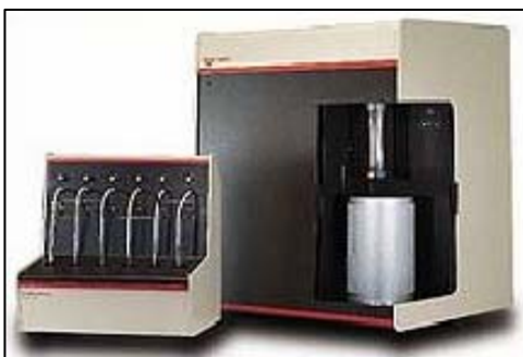
Figura N°17. Medidor de propiedades texturales MICROMERITICS TriStar 3000.
