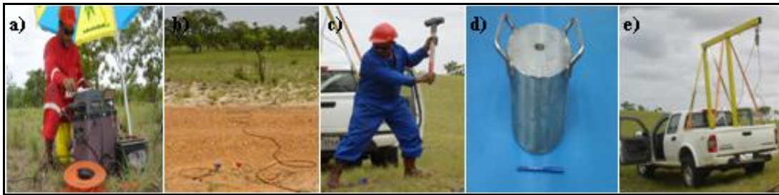
Figura 4.1. Algunos equipos utilizados en la adquisición: a) Sismógrafo Geometrics Stratavisor XP de 48 canales, batería de 12 v y cables, b) geófonos de 4,5 Hz (rojos) y 10 Hz (azules), c) mandarria de 20 lb, d) masa de acero de 150 kg y e) vehículo pick-up con estructura metálica.
