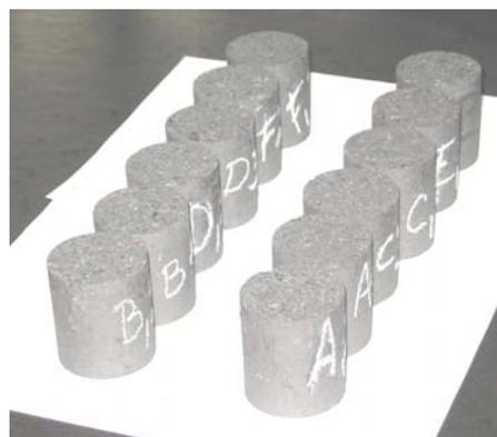
Figura 3.7 Probetas anódicas de 60 mm. de longitud y 50 mm de diámetro.
