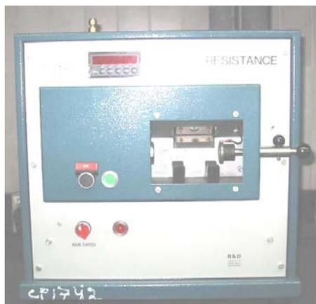
Figura 3.4 Equipo utilizado para medir la resistividad eléctrica modelo RDC – 145.
