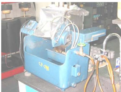
Figura 3.5 Máquina cortadora de probetas.
