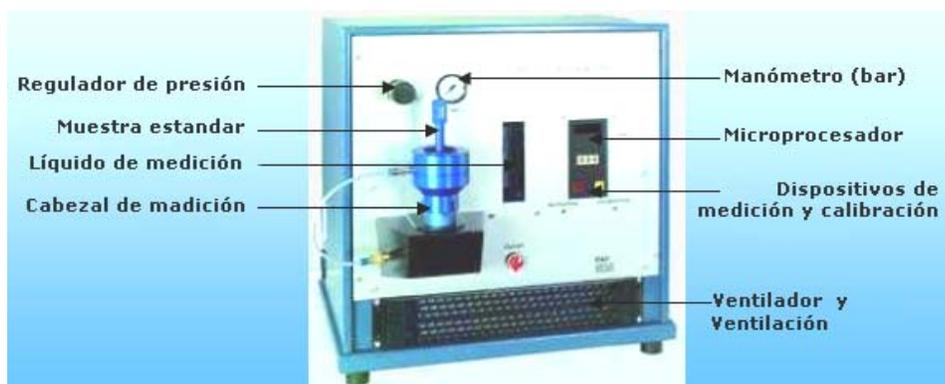
Figura 3.8 Equipo modelo RDC-145 utilizado para la medición de la permeabilidad al aire.<sup>(8)</sup>
