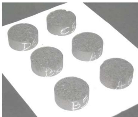
Figura 3.6 Probetas anódicas de 20 mm. de longitud y 50 mm de diámetro.
