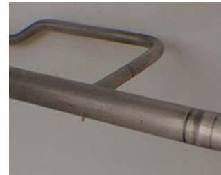
Figura 34. “T” con cambio de diámetro soldada
