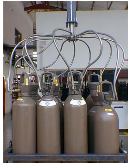
Figura 29. Curvatura actual de los flexibles acoplados a los cilindros
