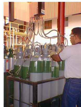
Figura 10. Montaje de un Proceso de Llenado
