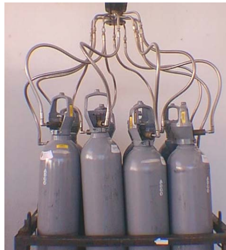
Figura 27. Curvatura original de los flexibles acoplados a los cilindros
