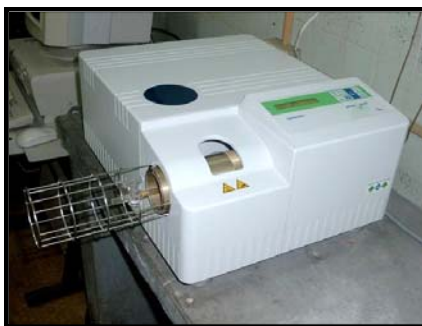
Figura N°6: Equipo para Termogravimetría (TGA), marca Mettler Toledo, modelo TGA/STDA 851°.
