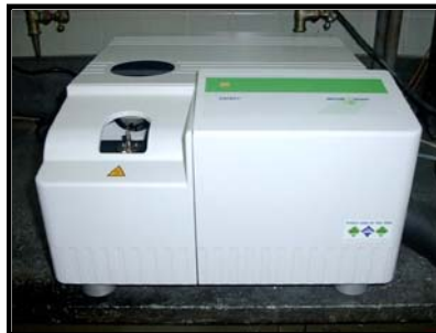
Figura N°5: Equipo para ensayos de Calorimetría Diferencial de Barrido, marca Mettler Toledo, modelo DSC821°.
