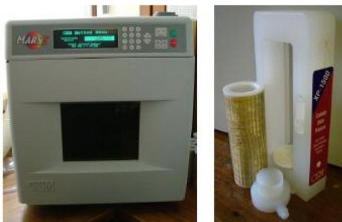
**Figura 20** Equipo CEM MARS 5000, reactor y protector.
