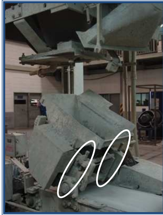
Figura N°22. Pernos delanteros de la empastadora.
