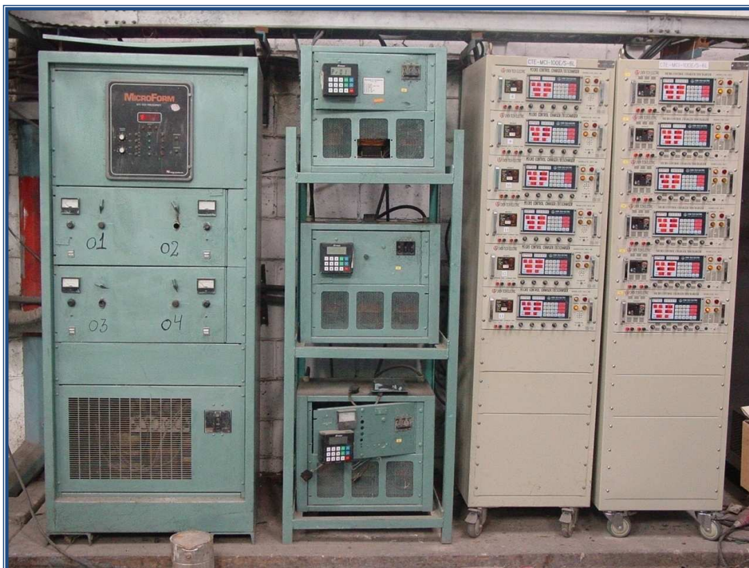
Figura N°28. Cargadores manuales (izquierda) y cargadores automáticos (derecha).
