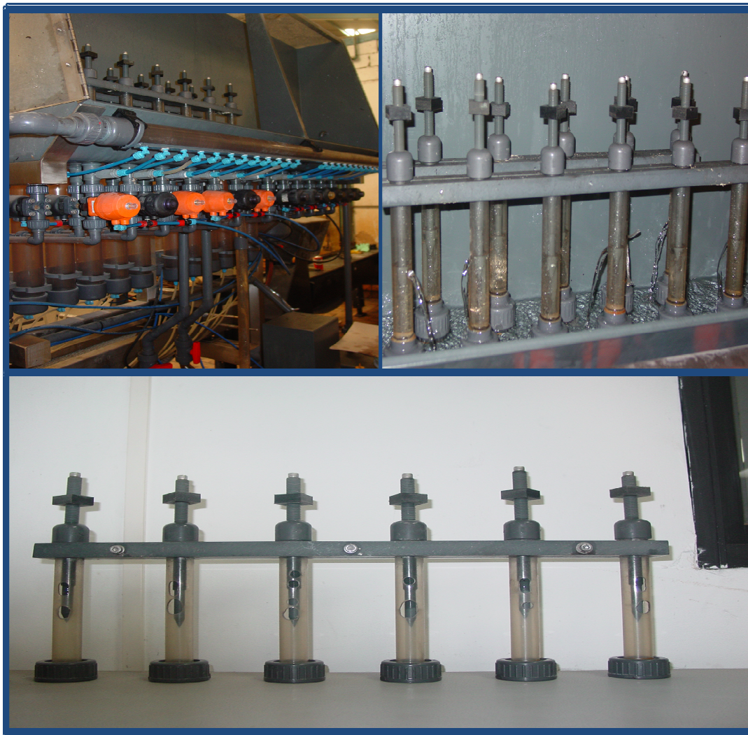
Figura N°26. Un juego de tubos de medición para baterías R-645.
