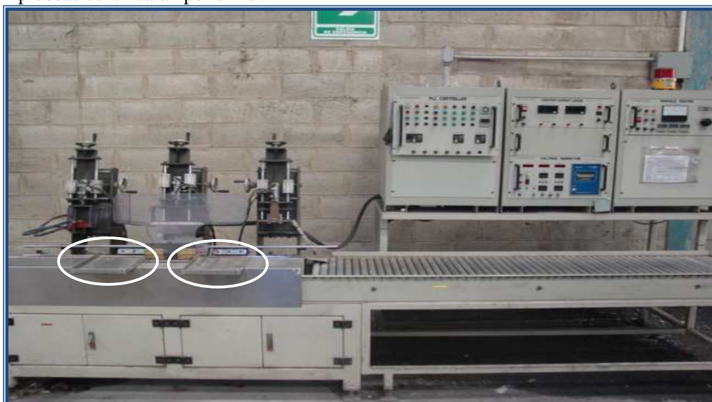
Figura F. Zonas de expulsión de batería por rechazo.
