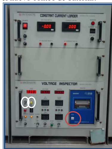
Figura D. Botones y switches de la impresora interna y reseteo de conteo.
