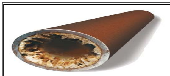
Figura 3. Incrustación en tubería de producción. Fuente: Crabtree et al. (1999)
