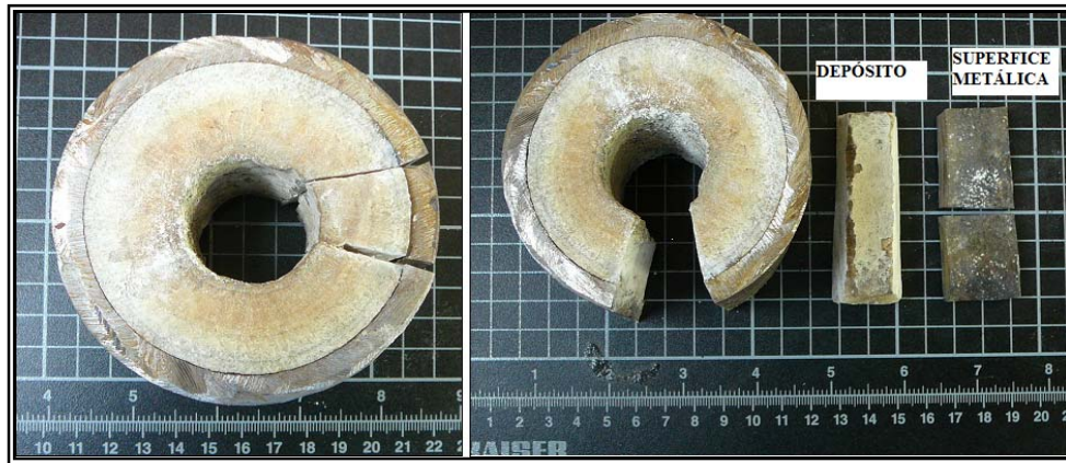
Figura 21. Apariencia macroscópica de la muestra extraída de la tubería de producción del pozo.
