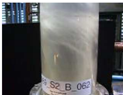
Figura IV.11. Centrifugación o vórtice formado por encima del cilindro dispuesto sobre el cono
