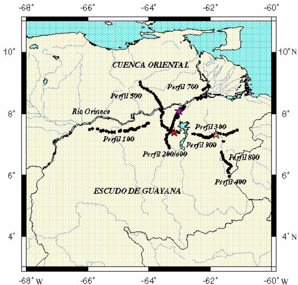
Figura 2: Ubicación de los 9 perfiles durante la adquisición sísmica de refracción del proyecto ECOGUAY, en la zona norte del Escudo de Guayana. Chalbaud (2000)
